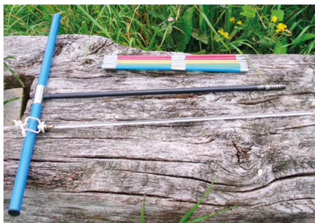
• Foto 1. Succhiello di Pressler per carotaggi • Foto T. Axelson in Wikimedia Commons
